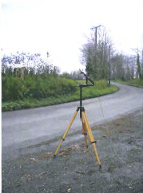
Antenne dipôle biconique de précision
